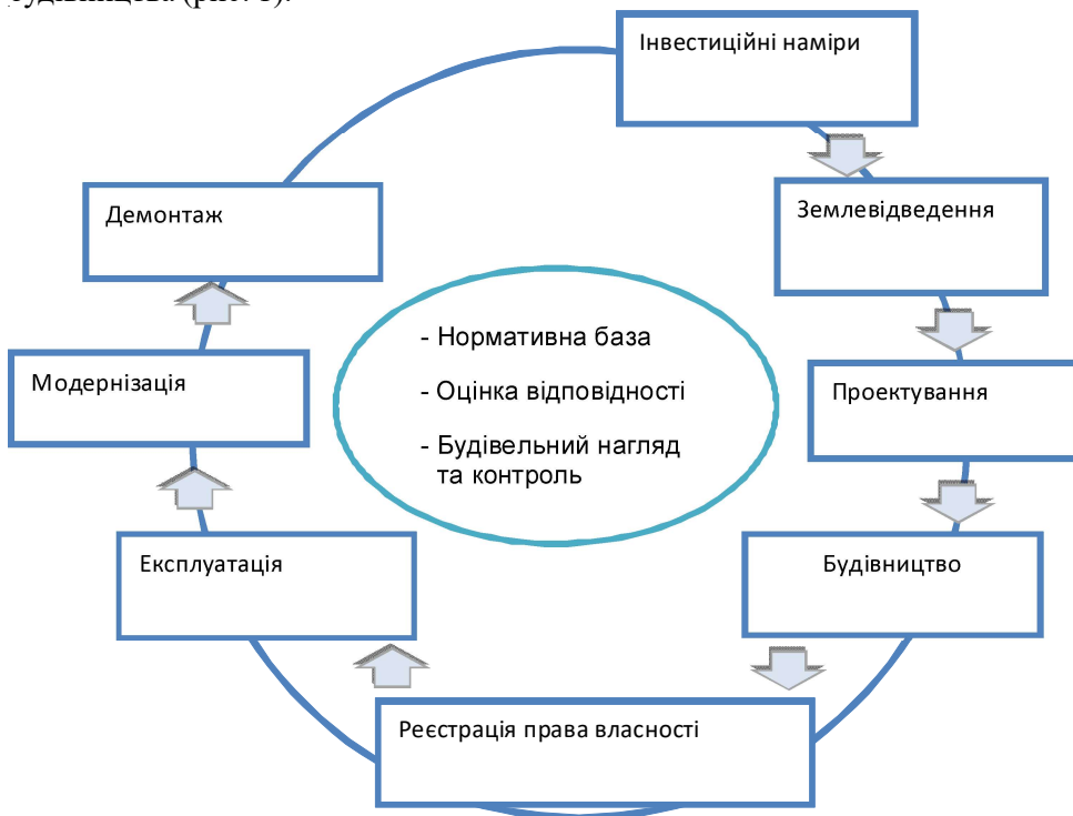
Рис. 1. Життєвий цикл об'єкта будівництва
